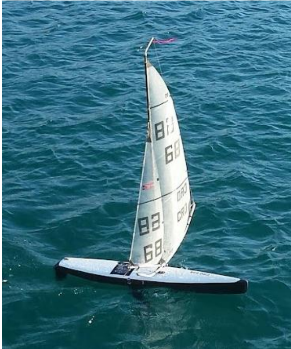
Slika 8 – Okretljiva (eng. swing) snast na Marbleheadu
