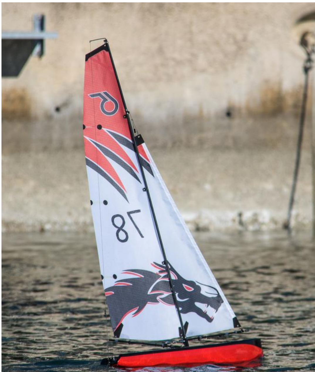
Slika 7 - Klasična snast bez pripona na DF65
