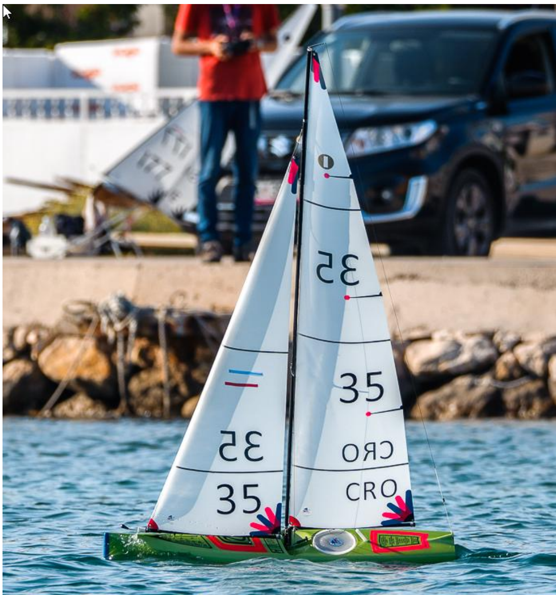
Slika 5 - Klasična A snast na modelu Kantun 2 klase IOM
