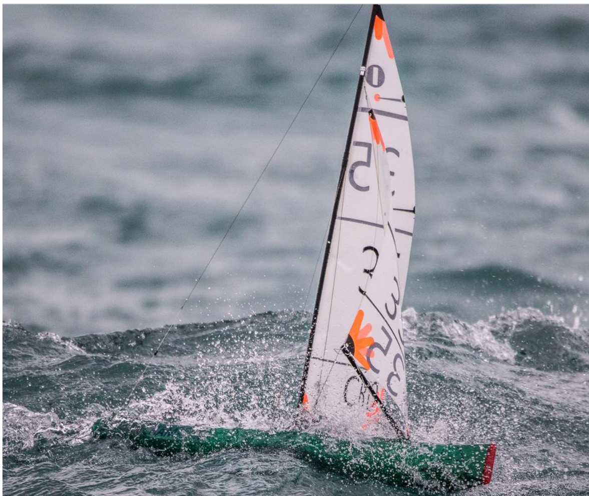
Slika 6 - Klasična C snast na modelu Kantun 2 klase IOM
